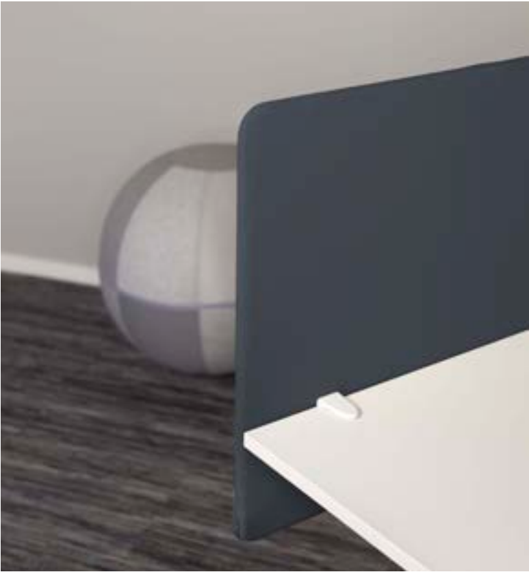
Ett kraftigare alternativ till ScreenIT Standard som klarar upp till 25 kg i belastning. Uppbyggd med en 16 mm tjock MDF-skiva klädd i skumlaminerad textil med en total tjocklek på 26 mm. Hålbild från ytterkant: 250 mm.
