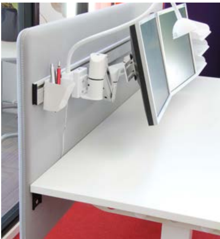
Funktionslist monteras på en förstärkt bordsskärm eller direkt på vägg. Rekommenderad monteringshöjd av list, 310 mm ovan bord till ovankant av list.
